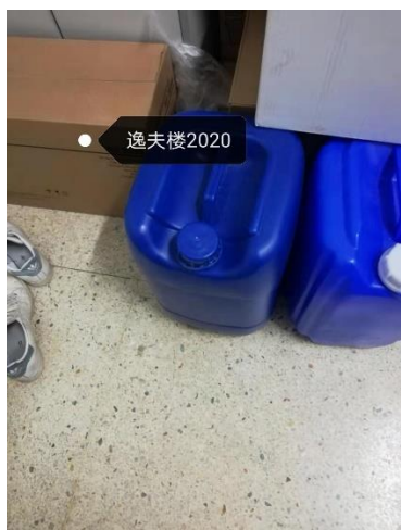
逸夫楼 2020—废液桶未张贴标签且无防漏托盘。
