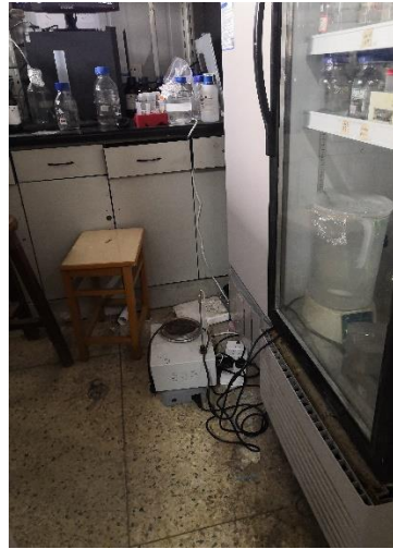
生科楼 C7021—接线板直接放置于地面使用，负责人曹慧（左图为初查，右图为复查）
