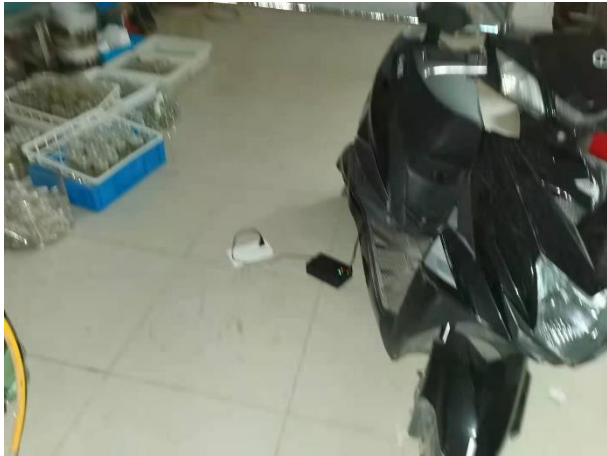
生科楼-B1021 农业机电实验中心：乱拉插线板；电动车在实验室内充电；废液桶未贴标签；实验垃圾未使用黄色垃圾袋
